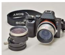
神村さんの撮影機材。ソニーα7Sにティルトが可能なアダプターをつけたコンタックスピオゴンT*21 mm F2.8 GとピオゴンT*28 mm F2.8 G。
